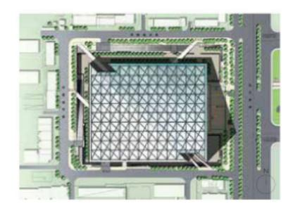
侨福芳草地是一个集商场、办公、酒店为一体的综合商务楼。建筑由 2 高 2 矮 4 个相对独立的单元组成,坐落在一个 10m 深的下沉花园上。建筑底层相互连通,上部由一个巨大的、能自由呼吸的环境保护罩包覆,能够自动应对不断变化的天气、温度、太阳角度、湿度和风向。环保罩高度超过 80m,立面采用单层玻璃,屋顶采用 ETFE 半透明膜。为了满足内部建筑高度的要求,环保罩形状为三角形,屋顶沿西面和北面倾斜。
