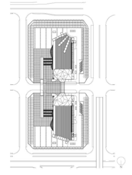
深圳文化中心由中心图书馆和深圳音乐厅 两部分组成,两栋建筑之间是将二者连成一体 的公共文化广场,形成一个面向市政厅一中央 绿化带一莲花山的开放空间。音乐厅和图书馆 入口处的两个钢结构玻璃体分别被称为"金树" 和"银树",寓意"文化森林"。中心图书馆的 设计藏书量为500万册。阅览室为无墙开放 空间,共6层。各层实现自然采光和通风,并 铺设地面线槽以适应书架、桌椅等的变化更新。 报告厅分为两层,设置了升降台、投影机、同
